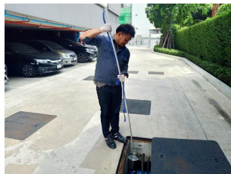
บริเวณหลังออกจากระบบบำบัดน้ำเสีย- บ่อตรวจคุณภาพน้ำ ชุดที่ 2
